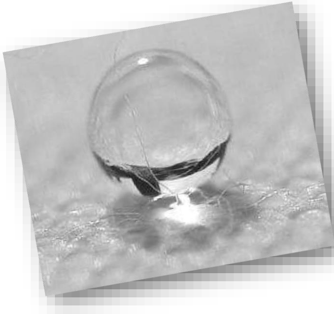
Gambar 2.4 Aplikasi nanoteknologi pada industri kain. Bahan kain yang dilapisi filamen-filamen nanosilikon akan menahan air sehingga mencegah air untuk membasahi bahan kain.
