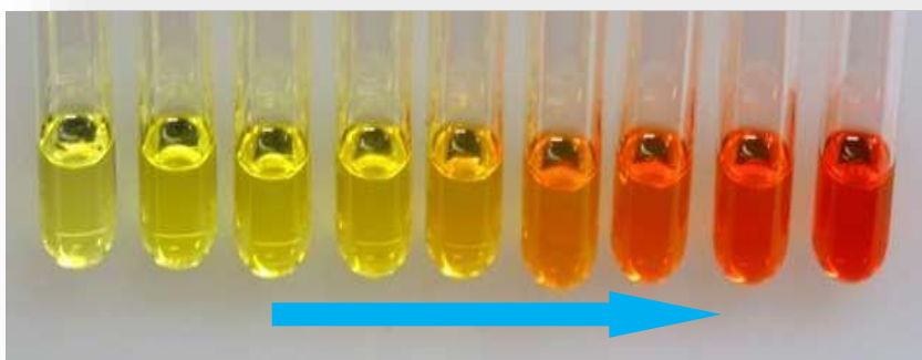
Gambar 6.2 Warna nanopartikel perak bergantung pada ukuran partikelnya. Anak panah menunjukkan semakin besarnya ukuran nanopartikel perak.
